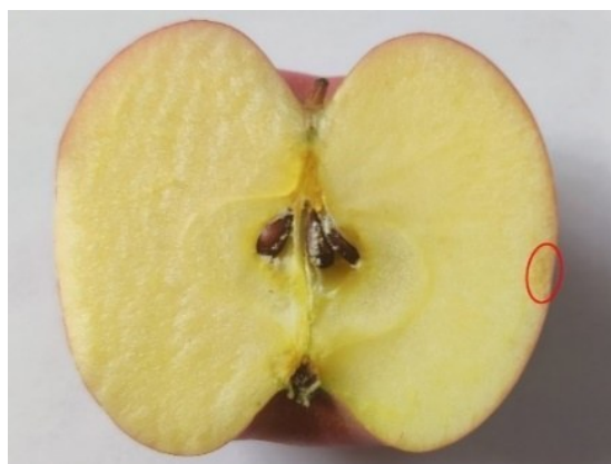
图 15 苹果经最优组合下气力输送后的损伤
